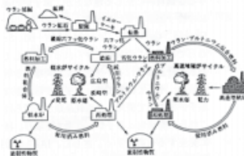
核燃料サイクルはウラン資源を有効に利用するためとされるが、原水爆と原子力発電はともこのサイクルの中から生み出される。なお、日本では軽水炉サイクルの再処理濃縮は未完成で、高速増殖炉サイクルにいたっては世界各国とも未完成である。
