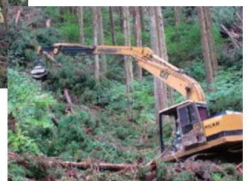
写真右：伐採された間伐木を作業道上からロングリーチグラブにより引き出している様子
